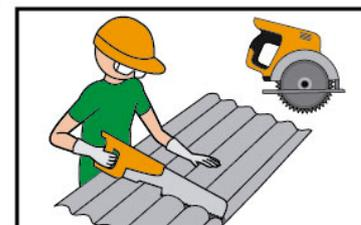
Use lápis colorido para marcar a telha corretamente. Corte a telha com serrote ou serra elétrica com discos de vídea.
